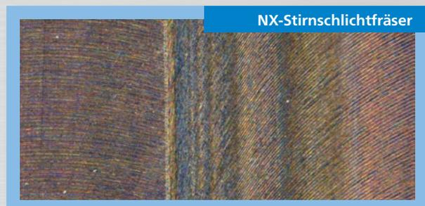
Material: Inox 1.4301, Ra: 0.11 µm, Rz: 0.62 µm
