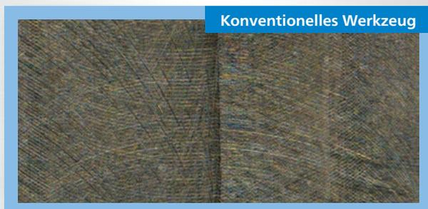
Material: Inox 1.4301, Ra: 0.35 µm, Rz: 1.73 µm
