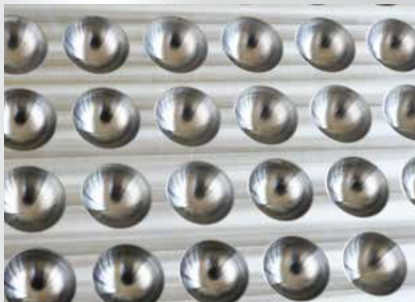
Precíziós marású gömbsüveg ( \varnothing = 5 \text{ mm} )
