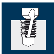
Fresatura di filetti con smusso
