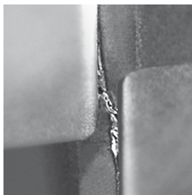
Utensile riaffilato (ReTool®) dopo un percorso d'intervento di 480 min
