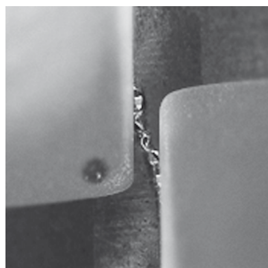
Utensile nuovo dopo un percorso d'intervento di 480 min
